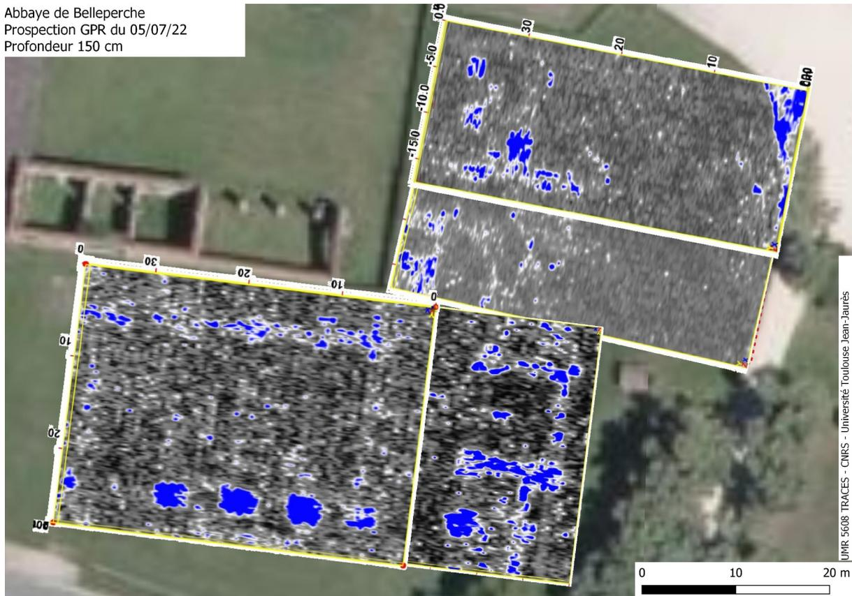
Figure 8 : Cordes-Tolosannes (82) - Mission du 05/07/2022 – Représentation 2D à 150 cm de profondeur
