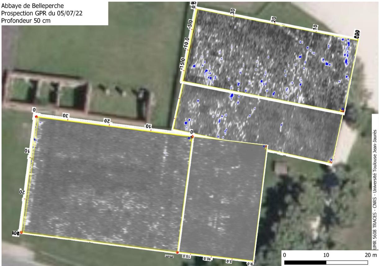
Figure 6 : Cordes-Tolosannes (82) - Mission du 05/07/2022 – Représentation 2D à 50 cm de profondeur
