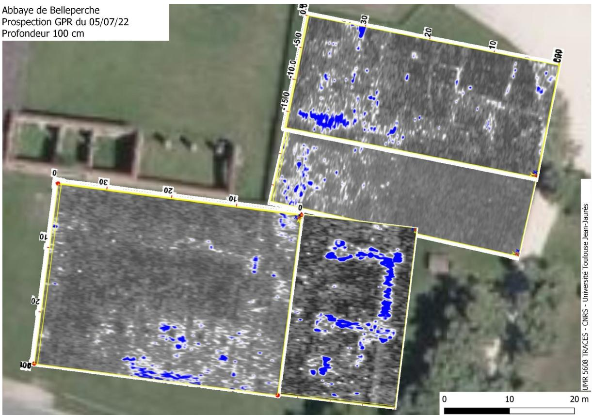
Figure 7 : Cordes-Tolosannes (82) - Mission du 05/07/2022 – Représentation 2D à 100 cm de profondeur
