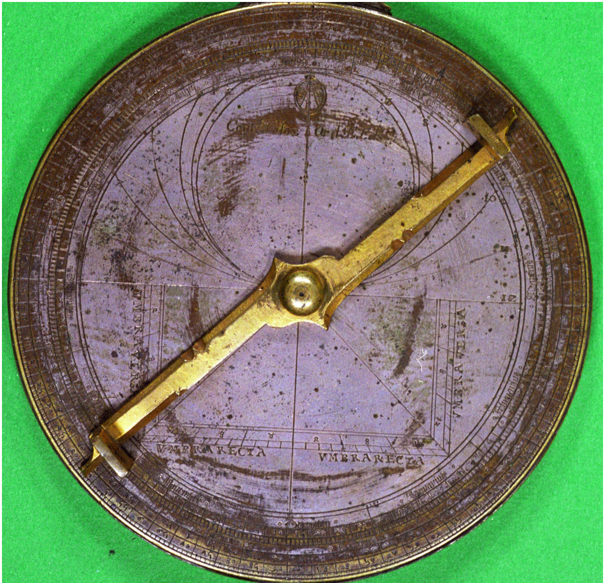
Figure 7: L'alidade montée au dos de la mère
