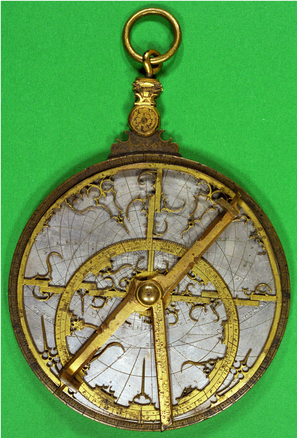
Figure 6 : Le verso de l'astrolabe, avec un tympan, l'araignée, l'alidade (barre diagonale) et l'ostensor (barre verticale). L'alidade est montée en principe au dos de la mère
