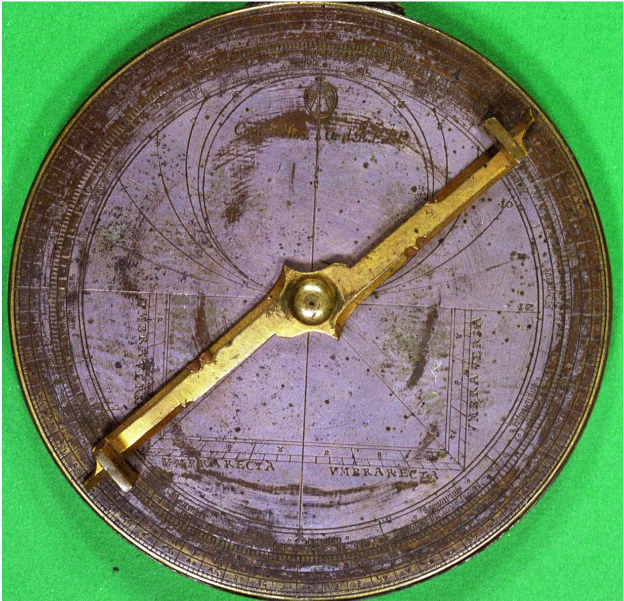
Figure 7: L'alidade montée au dos de la mère
