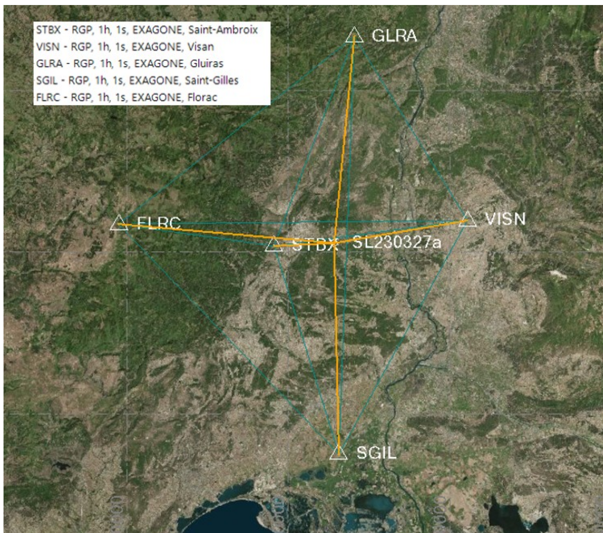
Figure 4: Les 5 stations de références du RGP entourant les points du levé de Montclus
