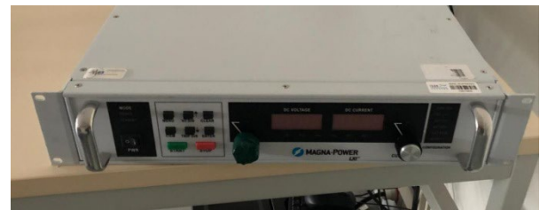
Figure 7. Alimentation électrique utilisée pour générer la différence de potentiel entre les électrodes.
