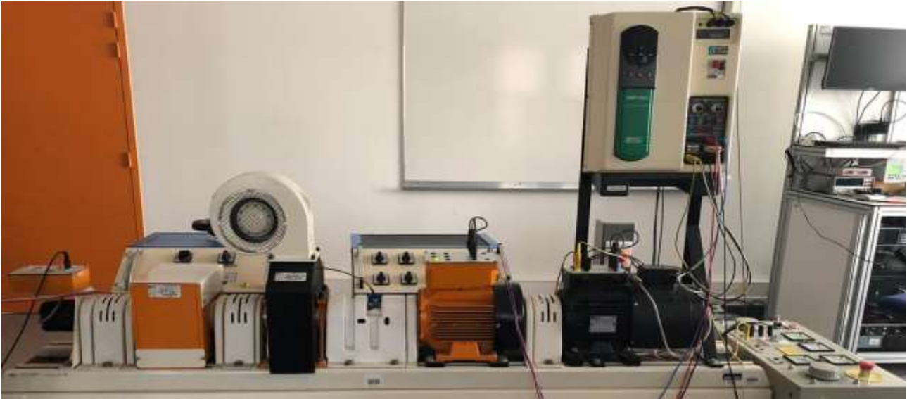
Figure 4 : Système utilisé pendant le cours, dans lequel on trouve : alimentation triphasée variable (en bas à droite), moteur asynchrone (en bas au centre à droite, en noir), variateur de fréquence commercial (en haut au centre à droite), générateur synchrone (en bas au centre, en orange), contrôle de vitesse et de couple (en bas au centre, en blanc), frein électromagnétique (en bas à gauche).
