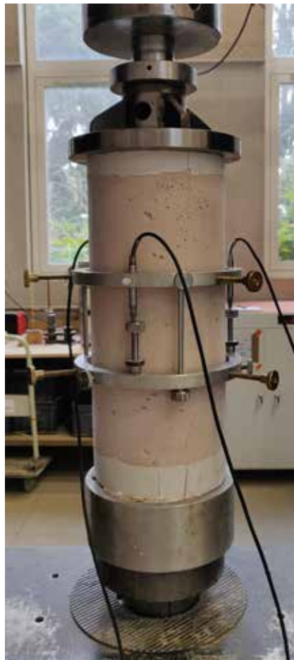
Mesure du module d'élasticité du BARBE
