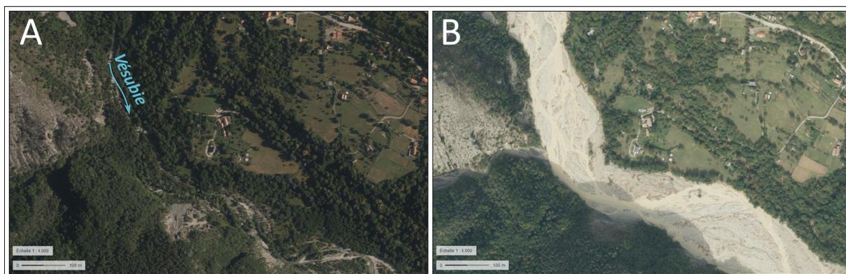
Figure1 : Métamorphose fluviale de la Vésubie en aval de Saint-Martin Vésubie suite à la crue du 2 octobre 2020 (source : orthophotos IGN 2017 (A) et 2020 post-crue (B)).
