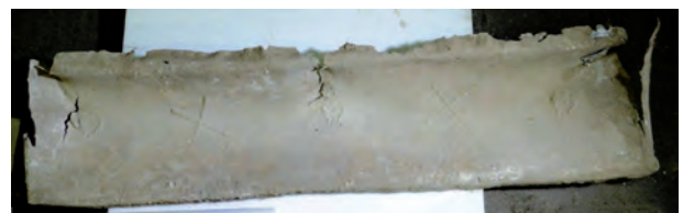
Fig. 25 - Fluage, déformation, déchirures et manques du couvercle (© SAAM).
