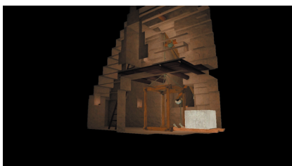
L'intérieur de l'encoche, un système pour faire pivoter les blocs.
