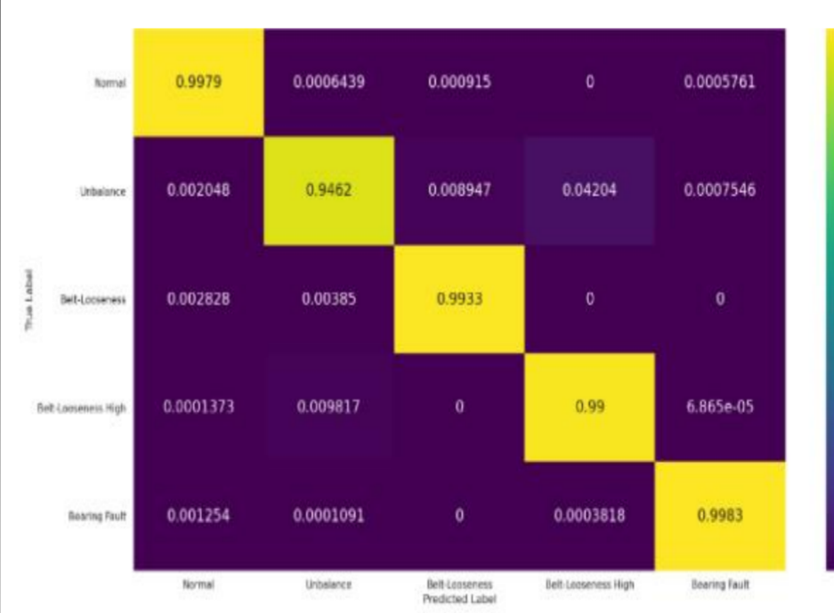
Matrice de confusion du modèle réseau de neurones sur la partition test Normal / Déséquilibre / Relâchement de la courroie Important relâchement de la courroie / Défaut de roulement.
