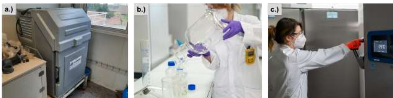
161 Figure 2. (a) Préleveur automatique situé au site de Clichy, (b) Conditionnement des échantillons pour stockage, (c) 162 Congélateurs (-80°C et -20°C) pour stockage sur le site de Colombes
