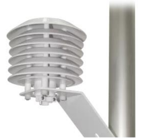
Abri ventilé pour capteur de T° ou T°/RH. Existe aussi à ventilation forcée (ventilateur)
