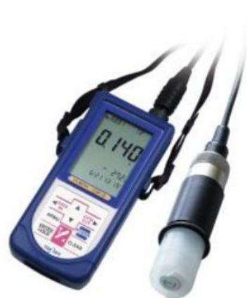
Sonde de mesure de CO 2 dans l'air ou les liquides
