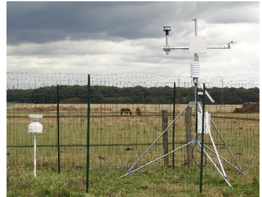
Abri ventilé pour capteur de T° ou T°/RH. Existe aussi à ventilation forcée (ventilateur)
