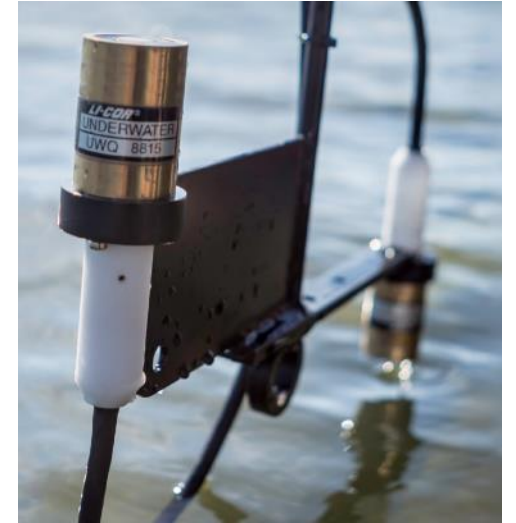
Exemple d'un capteur de rayonnement PAR « designé » pour résister à l'immersion (Crédits photo : LI-COR)
