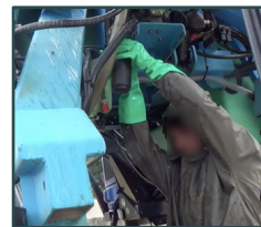
Figure 5 – Retrait d'un filtre (1)
