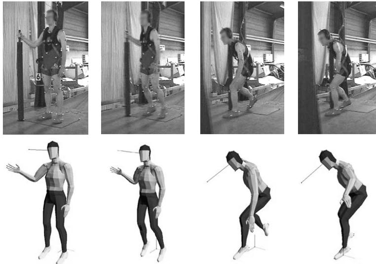
Figure 3 : comparaison d'extraits d'une vidéo d'un essai et d'un mouvement reconstruit. L'environnement (barre de maintien, sol etc.) n'est pas représenté
