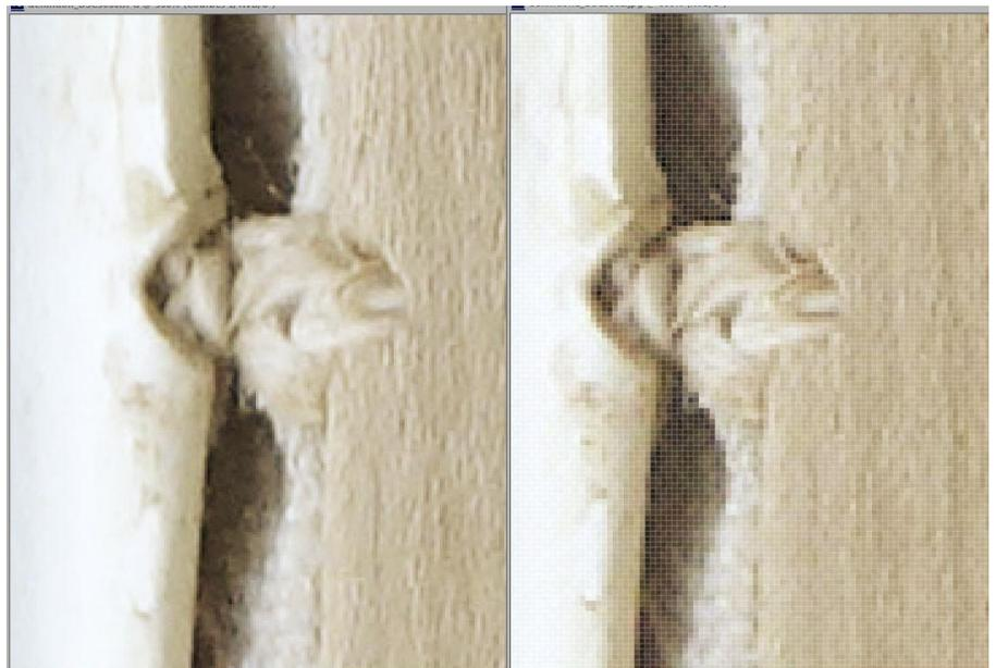
à partir de la prise de vue de gauche, détails obtenus de même dimension avec un capteur de 20 M pix à gauche et 5 M pix à droite
