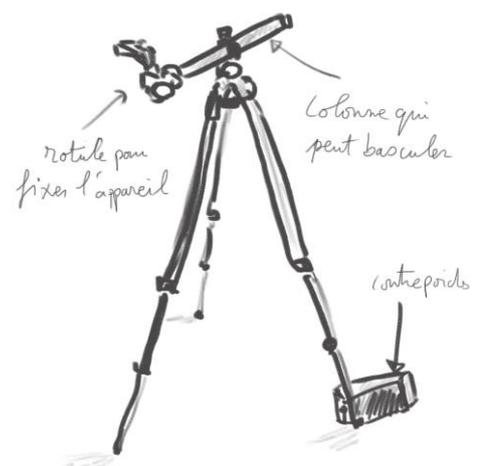
le statif ou le pied permet d'utiliser des vitesses lentes si vous manquez de lumière. si vous ne disposez pas de déclencheur souple, utiliser le retardateur.
