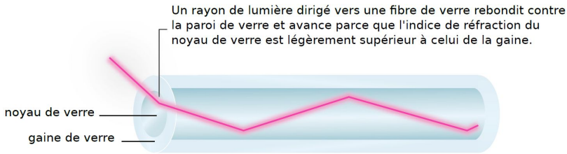
FIG. 58 – La fibre optique mesure environ 125 micromètres. Le cœur a généralement un diamètre d'environ 10 micromètres, soit moins qu'un cheveu. La lumière infrarouge, d'une longueur d'onde de 1,55 micromètre, présente les pertes les plus faibles. Elle est aujourd'hui utilisée pour les communications optiques.
