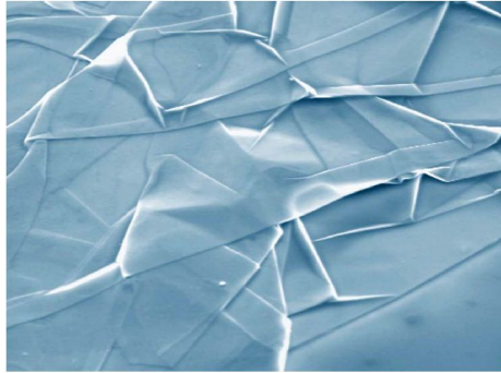
FIG. 64 – Comme un drap de soie. Feuilles de graphène pliées sur une plaque de silicium. L'image a été prise au microscope électronique à balayage, avec un grossissement d'environ 5 000.
