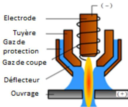
Figure 1: Principe de la découpe plasma [2]
