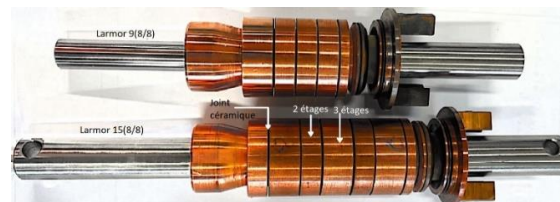
Figure 1: Conception modulaire de la torche plasma
