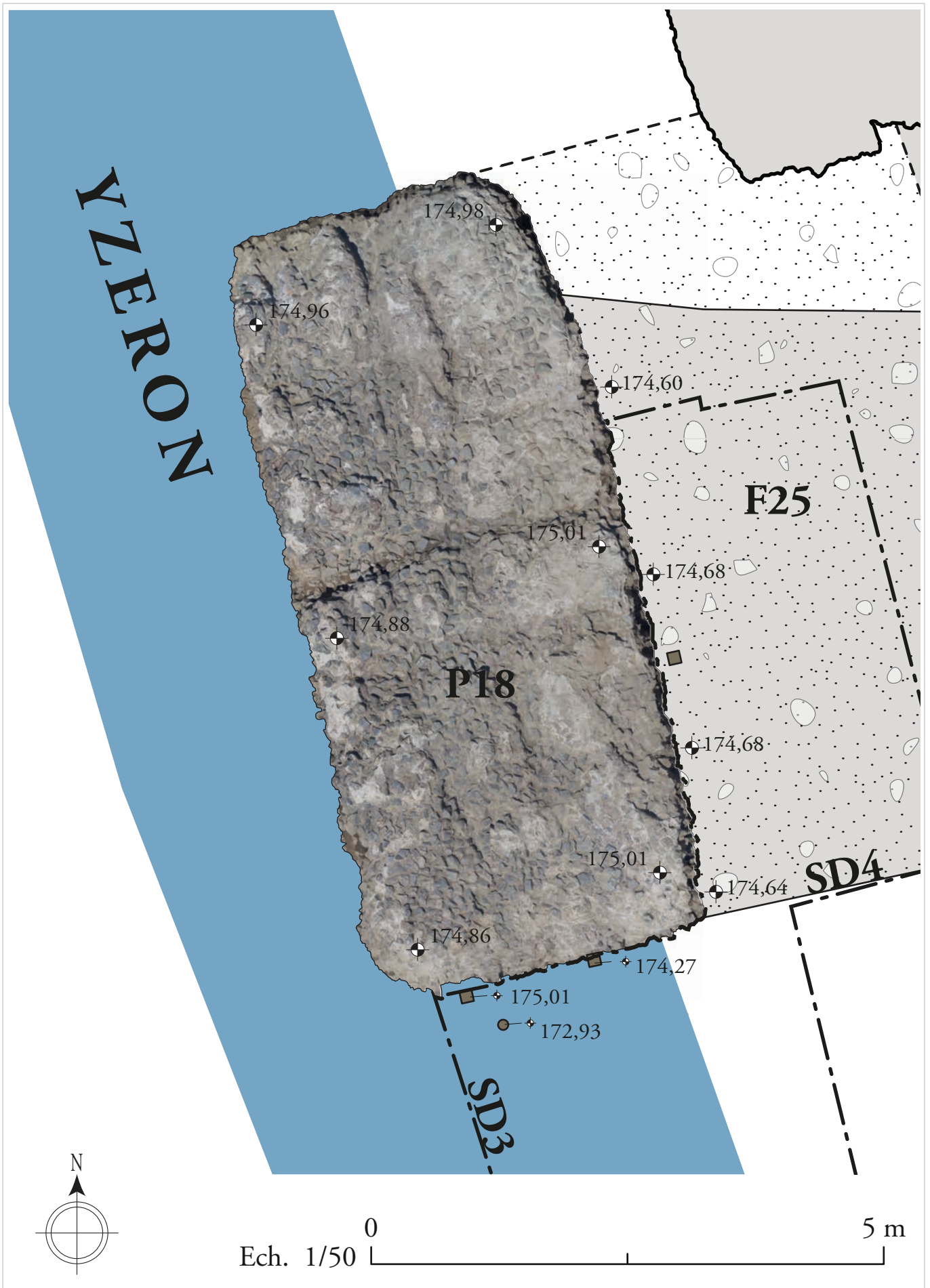
Figure 35 : Plan photogrammétrique de la pile 18 et localisation des pieux verticaux du coffrage de fondation (Éch. : 1/50) (DAO : D. Baldassari).
