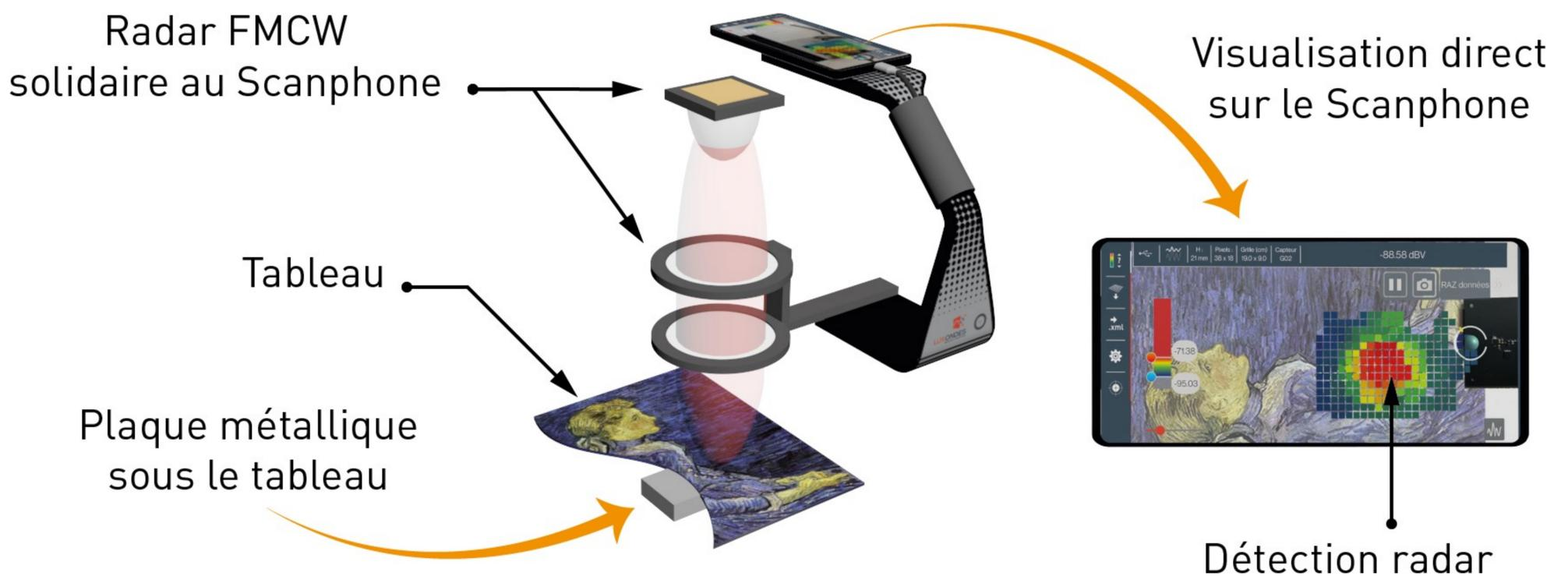
Le montage expérimental, illustré sur le schéma ci-dessus, associe un radar FMCW large bande intégré (122 GHz à 170 GHz), deux lentilles de 115 mm de focale et un smartphone (Scanphone/Luxondes) utilisant une interface de réalité augmentée. Une plaque métallique (4x8cm) est placée sous la peinture à l'emplacement de la bouche.
