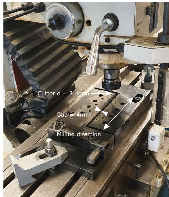
FIGURE 3 – Configuration de l'usinage
