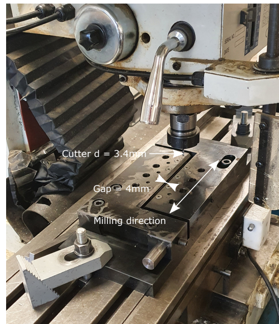
FIGURE 3 – Configuration de l'usinage
