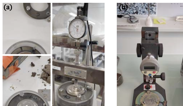
Figure 3. (a) Suivi du gonflement à volume constant (b) Appareil de mesure du retrait linéaire
