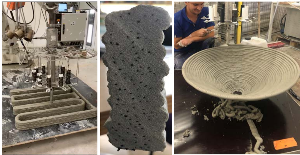
FIGURE 4. Prototype 2, XtreeE : impression avec fibres de carbone, uniformément réparties comme le montre la coupe de cordons au centre. Impression d'une structure fibrée avec anneaux de traction (droite).
