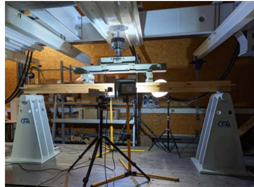
FIGURE 7. Montage de l'essai de flexion quatre points
