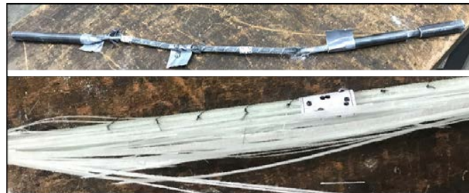
FIGURE 6. Modes de rupture typiques des armatures PRFV (en bas) et PRFC (en haut)
