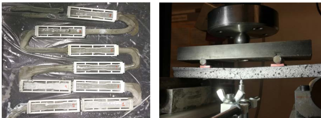
FIGURE 5. Moulage in-situ des éprouvettes de traction à gauche, essai de flexion 4 points à droite Des essais de traction et flexion ont été réalisés sur des cordons renforcés à différents taux de fibre
