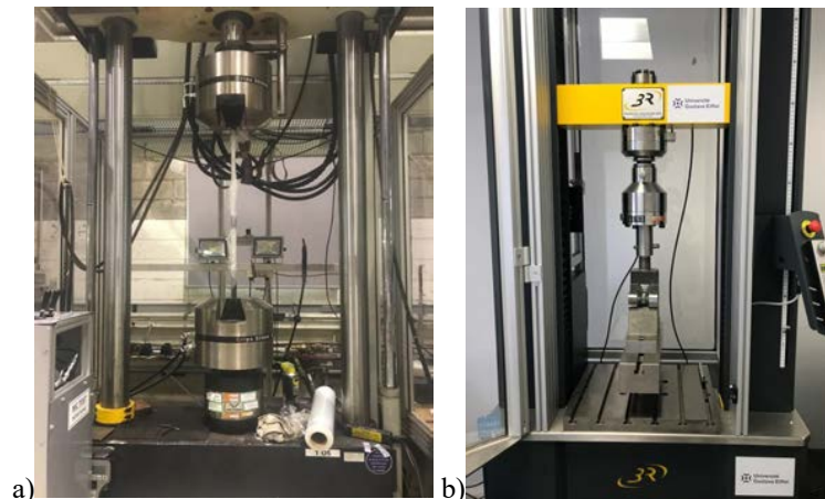
FIGURE 2. Essais de caractérisation en a) traction et en b) cisaillement inter-laminaire
