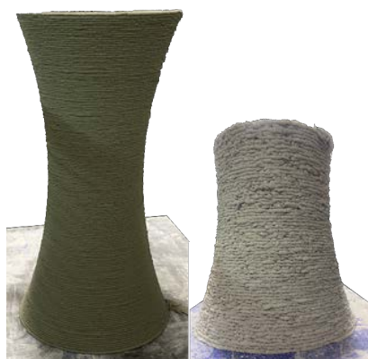
FIGURE 8. Impression 3D d'une hyperbole de 1m de haut, formule B à gauche, formule M4 à droite
