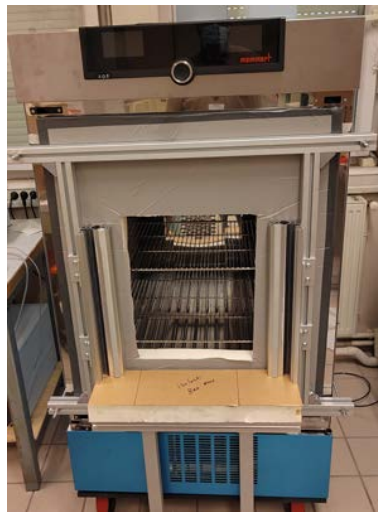
FIGURE 1. Présentation du bâti de fixation de la paroi et de l'enceinte climatique
