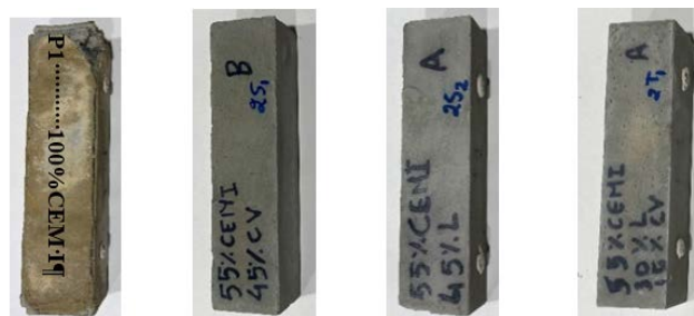
FIGURE 2. Dégradation visuelle des quatre mélanges après 70 semaines d'immersion
