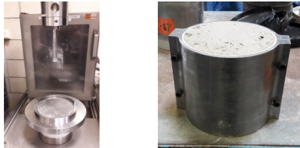
FIGURE 3. Essai de poinçonnement : poinçon monté sur la presse et échantillon confiné dans un moule d'acier
