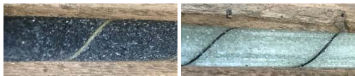
FIGURE 1. État de surface des armatures PRFC et PRFV étudiées
