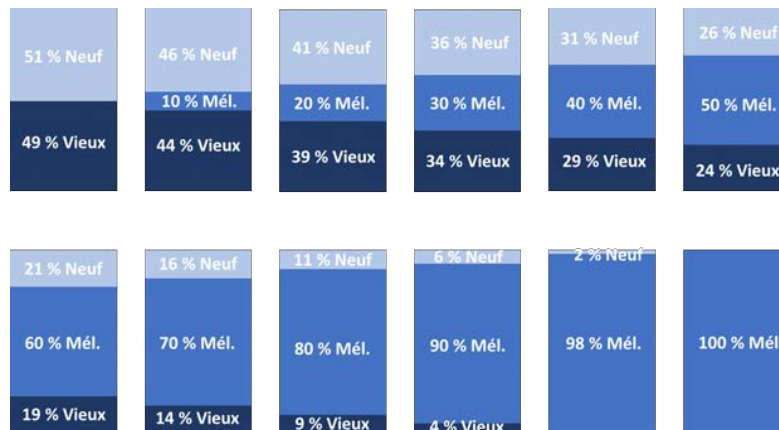
Figure 2. Les différentes étapes de mélange entre les mortiers neuf et vieux
