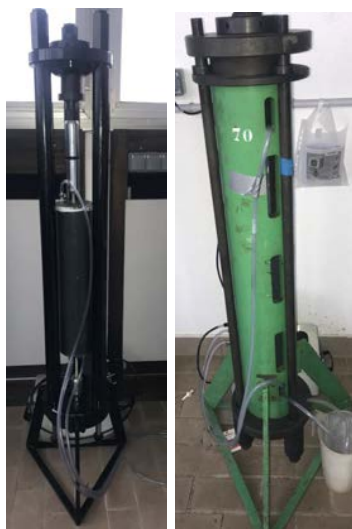
FIGURE 4. Bâtis de vieillissement VAC pour les éprouvettes de traction
