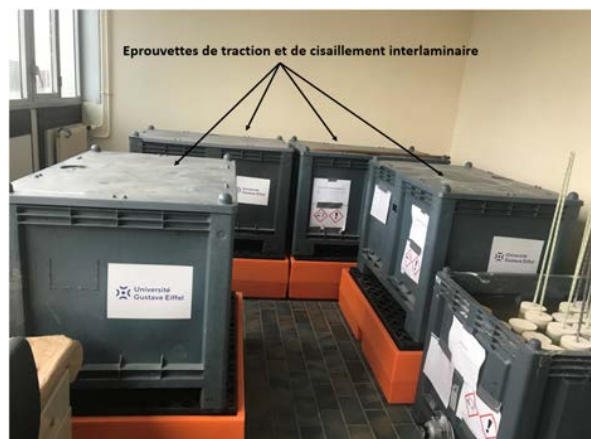
FIGURE 3. Salle de vieillissement des éprouvettes (VSC) contenant les bacs thermostatés
