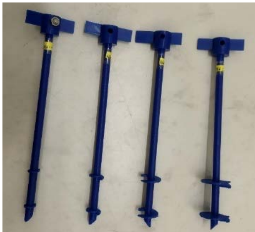
FIGURE 5. Exemples de pieux hélicoïdaux imprimés en 3D
