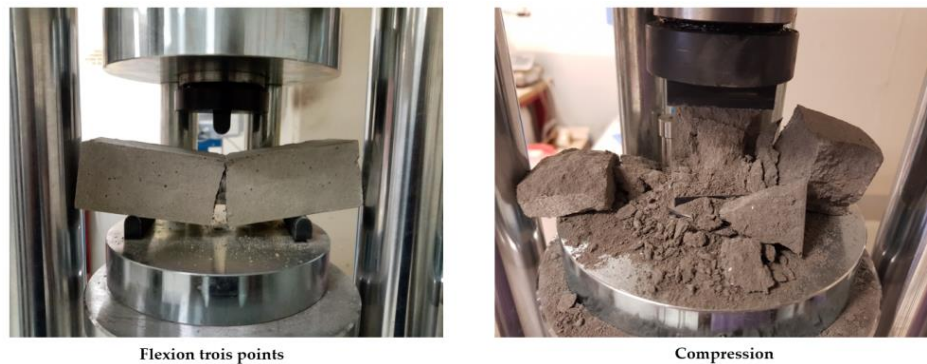
Figure 3 : Caractérisation mécanique en flexion et en compression d'éprouvettes de matrices minérales
