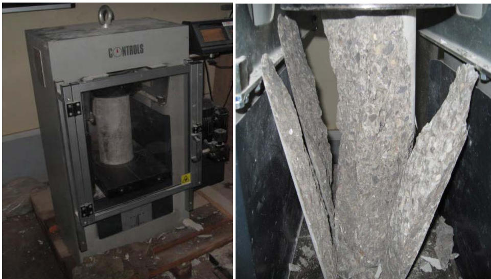
FIGURE 4.Ecrasement des cylindres en compression.
