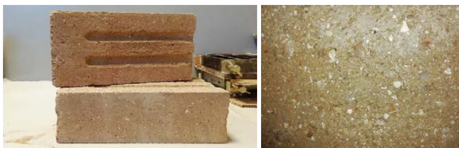
FIGURE 1. Blocs en terre comprimée étudiés (gauche) et surface du bloc (droite)
