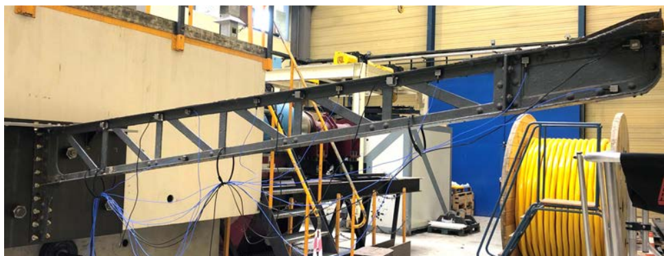
FIGURE 3. Poutre treillis instrumentée avec 12 accéléromètres pour les essais vibratoires.
