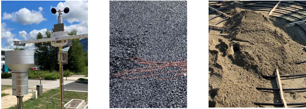
FIGURE 5. Station météorologique (gauche), pose des thermocouples dans la chaussée (milieu) et pose des sondes de température dans le stockage au fur et à mesure du remplissage de sable (droite)
