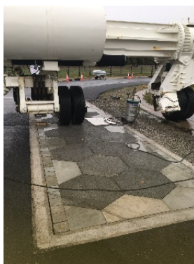
FIGURE 9. Essai de fatigue d'une section de CUD-SF sur le manège de fatigue de l'université G. Eiffel
