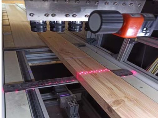
FIGURE 6. Scan des bois au Xyloprofil et mesure de la variation de la pente de fils
