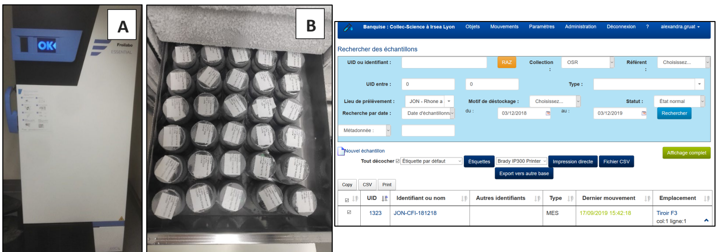
Figure 6 : Enceintes -80°C utilisées pour le stockage des échantillons de MES de l'OSR et interface Banquise utilisée pour la bancarisation des métadonnées (A : congélateur -80°C ; B : échantillons stockés dans le congélateur -80°C ; C : interface du logiciel Banquise)
