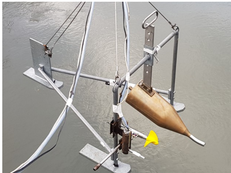
Figure 12: Bouteille de Delft - Mini pompe immergée et Moulinet Ott déployés depuis la passerelle à Grenoble Campus.
