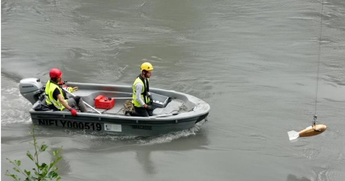
• Figure 11: Prélèvements combinés traîle - barque permettant d'optimiser la durée des jaugages solides.
