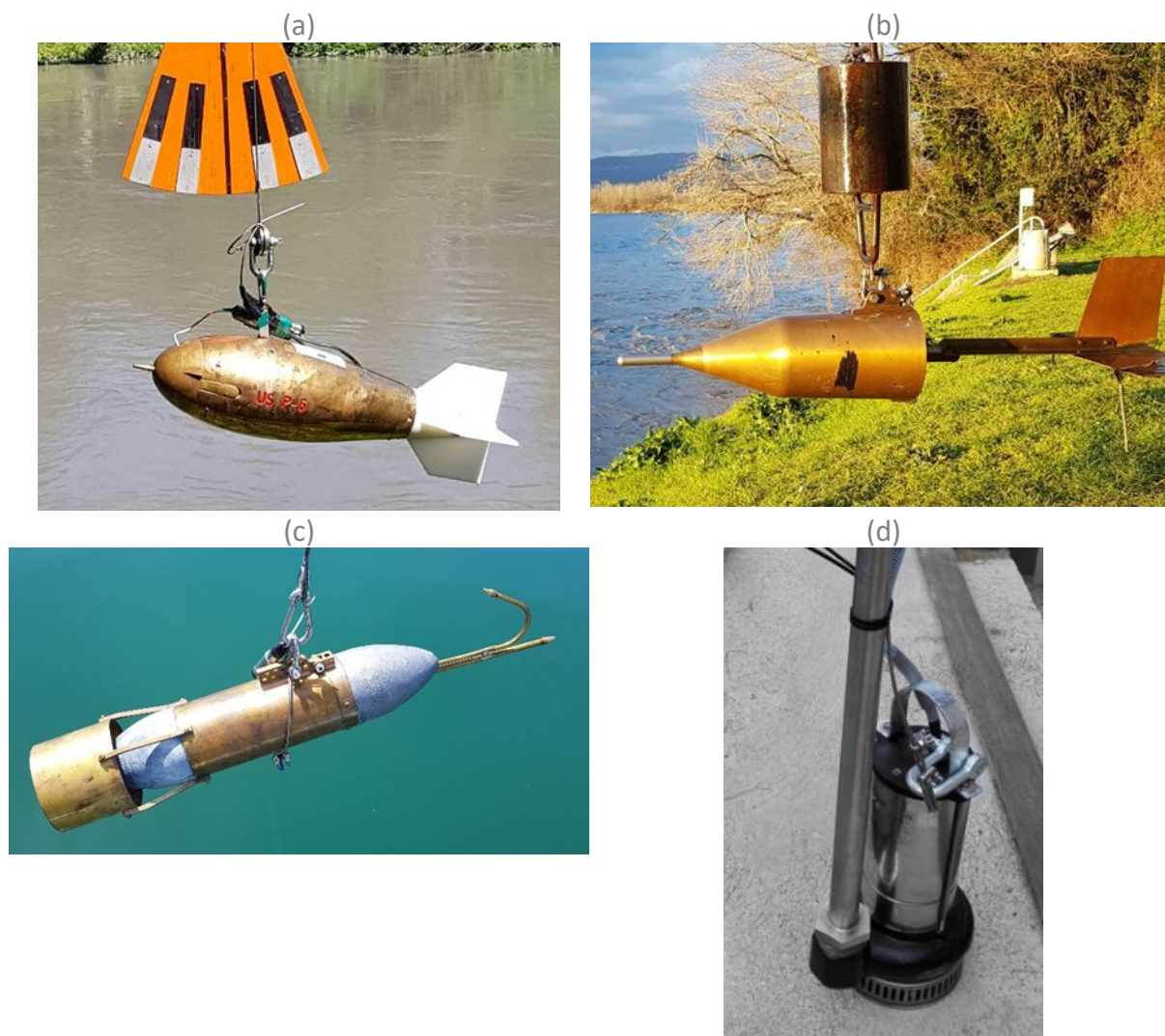
Figure 1: Différents types de préleveurs testés lors de cette étude : (a) US-P6, (b) Bouteille de Delft, (c) préleveur intégratif Nilsson, (d) pompe de prélèvement immergée.
