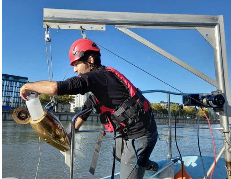
Figure 6: Déploiement du préleveur US-P6 depuis le treuil de l'embarcation Salmo d'INRAE.
