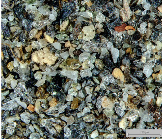
Figure 9: Echantillon de sable en suspension prélevé en sub-surface avec la bouteille de Delft le 26 mai 2021.
