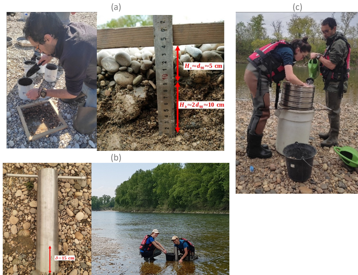
Figure 17: Méthodologie de mesure des stocks de fines par placette hors-eau (a ; Deng et al., 2023) ou placette en eau (b ; McNeil & Ahnell, 1964), et méthode de tamisage in situ (c)
