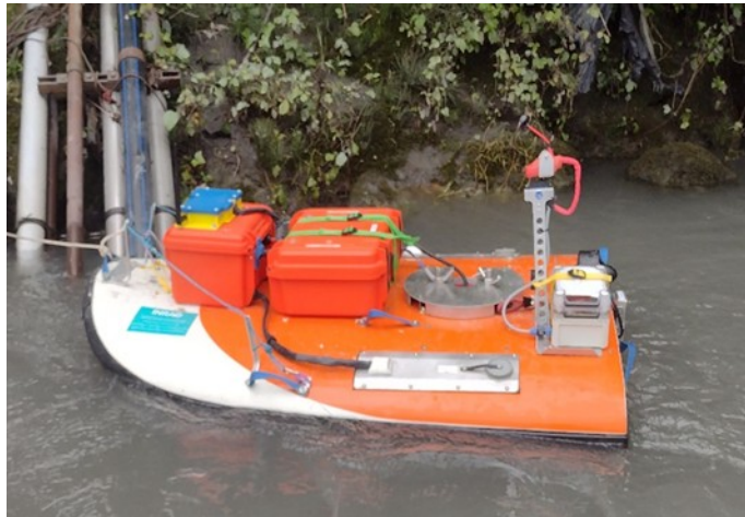
Figure 13: Drone aquatique motorisé pour les jaugeages liquides par ADCP.
