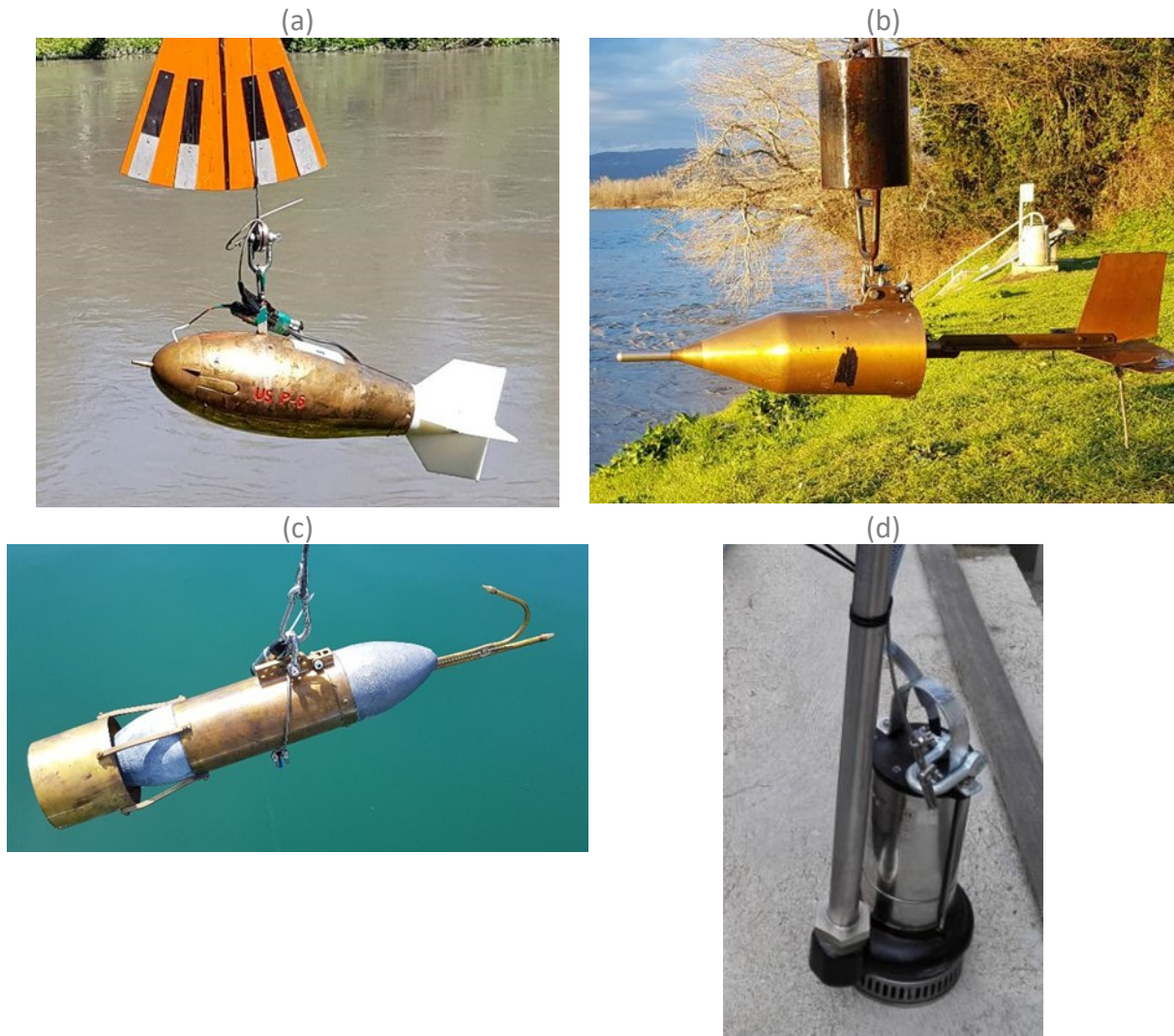
Figure 1: Différents types de préleveurs testés lors de cette étude : (a) US-P6, (b) Bouteille de Delft, (c) préleveur intégratif Nilsson, (d) pompe de prélèvement immergée.
