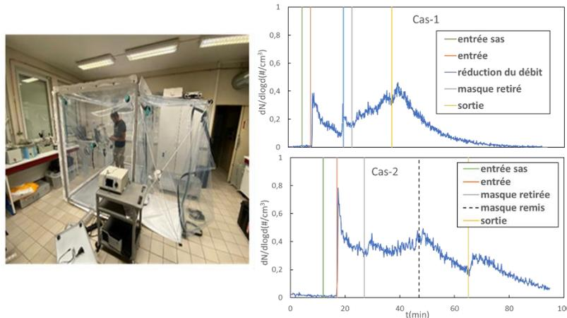
Figure 1 : (a) Image représentative du Bio-E-RATEs. (b) Exemples de l'évolution dans le temps de la concentration en particules « totale » (Biotrak) dans la chambre obtenues pour une même personne sur deux journée différente suivant deux protocoles expérimentaux différents.
