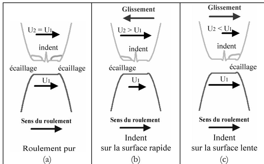
FIG. 3 – Site d'initiation d'écaillages dus à un indent.
