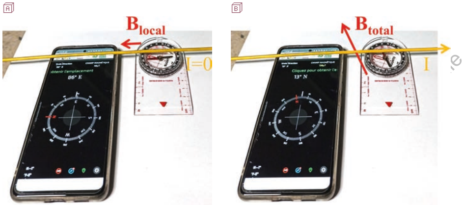
Figure 1 - Expérience d'Ørsted. (A) Le fil (jaune), à courant nul, est aligné sur le champ local indiqué par la boussole (numérique ou traditionnelle) - (B) Avec un courant non nul, le champ, repéré par les boussoles, tend à s'aligner perpendiculairement au fil.
