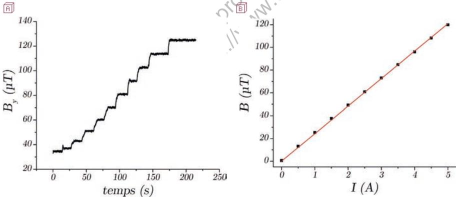
**Figure 4** - (A) Acquisition de  $B_y$  en fonction du temps par plateaux de courant  $I$  de 0,5 A toutes les dix à quinze secondes - (B) Champ magnétique sur chaque plateau en fonction du courant correspondant (carrés noirs) et régression linéaire (ligne rouge).
