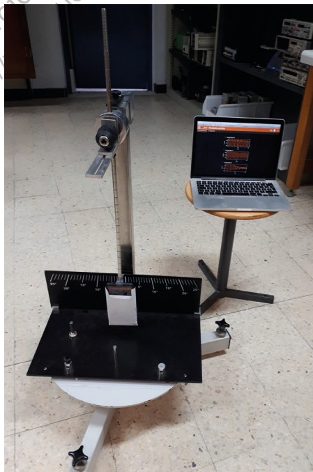
Figure 1 - Photo du dispositif pour la mesure de l'accélération de Coriolis
