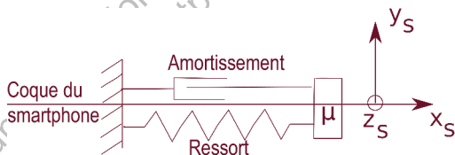
Figure 3 - Principe de fonctionnement d'un capteur d'accélération.
