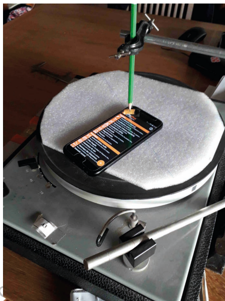
Figure 1 - Photo de l'expérience, détermination de la position du capteur d'accélération.
