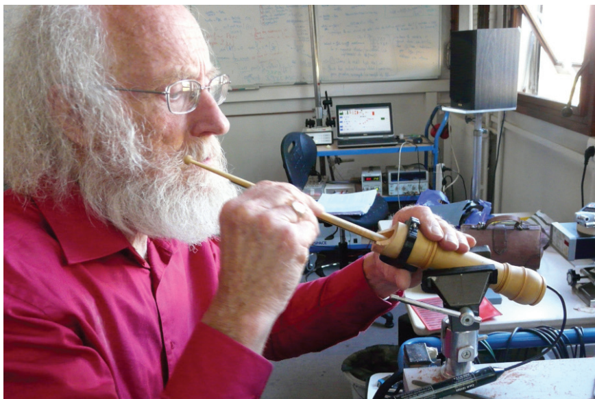
Fig. 4. Philippe Bolton au LMA: caractérisation des étapes de réalisation du canal de flûte à bec.
