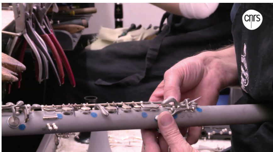
Fig. 5. Clétage d'un prototype de clarinette lors du projet ANR CAGIMA avec Buffet-Crampon, IRCAM et LPSM.
