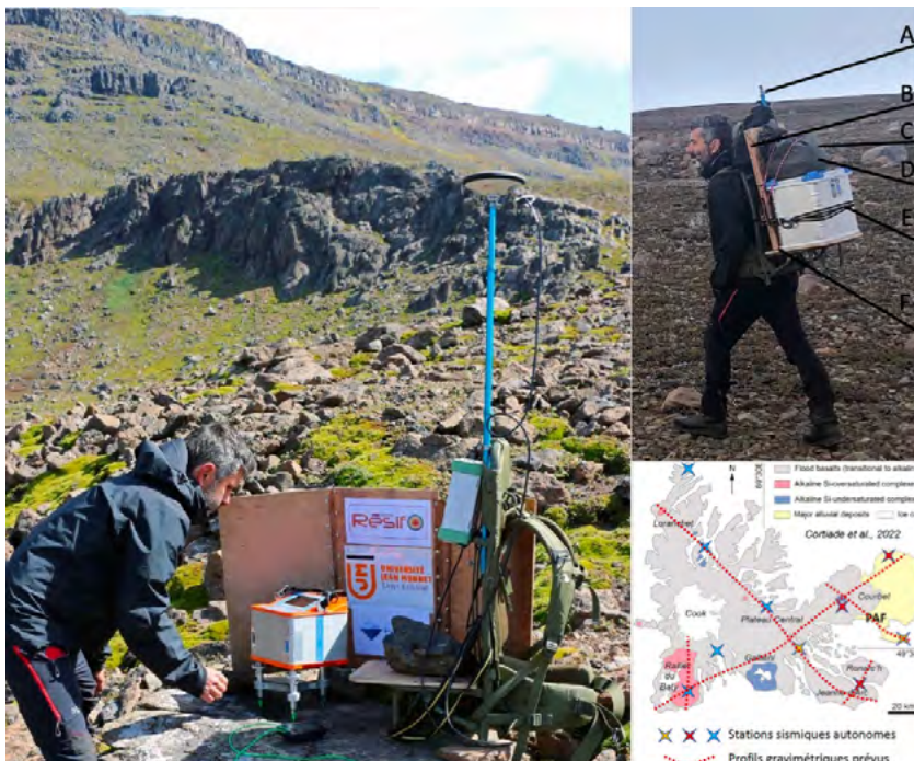
1 - Mesures gravimétriques et GNSS aux îles Kerguelen. A gauche, mesure protégée du vent. A droite, déplacement d'une station de mesure à une autre avec l'équipement (A : Support antenne GNSS, B : paravel, C : GNSS, E et D : Gravimètre CG6 et trépied ; F : claie de portage). En bas à droite, profils gravimétriques prévus sur l'île.
