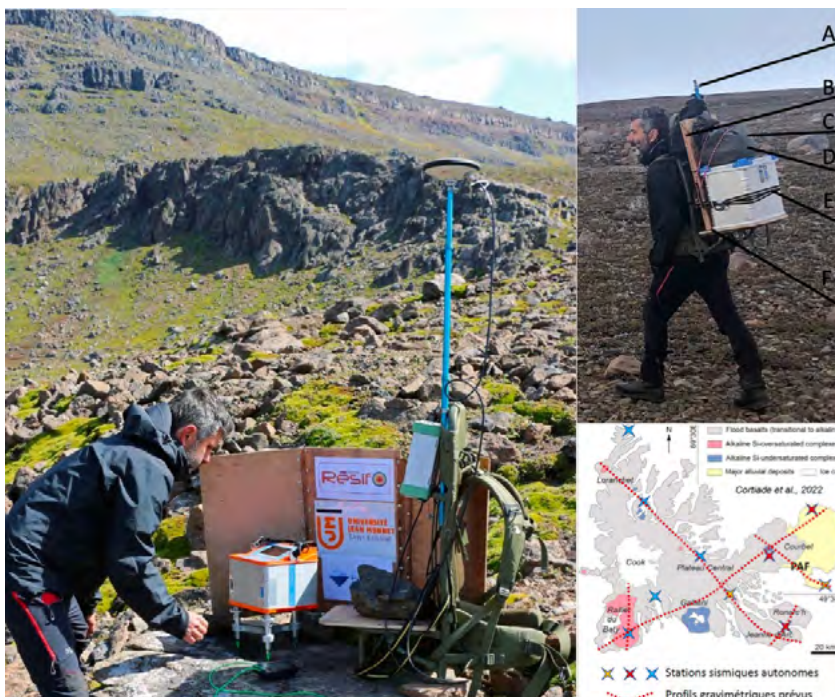
1 - Mesures gravimétriques et GNSS aux îles Kerguelen. A gauche, mesure protégée du vent. A droite, déplacement d'une station de mesure à une autre avec l'équipement (A : Support antenne GNSS, B : paravent, C : GNSS, E et D : Gravimètre CG6 et trépied ; F : claie de portage). En bas à droite, profils gravimétriques prévus sur l'île.
