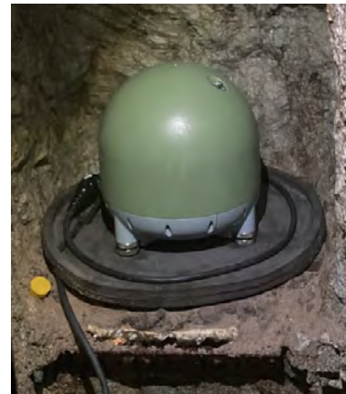
1- T360-GSN-Vault installé au fond de la mine de la station ECH (photo prise avant l'installation de la protection thermique).
