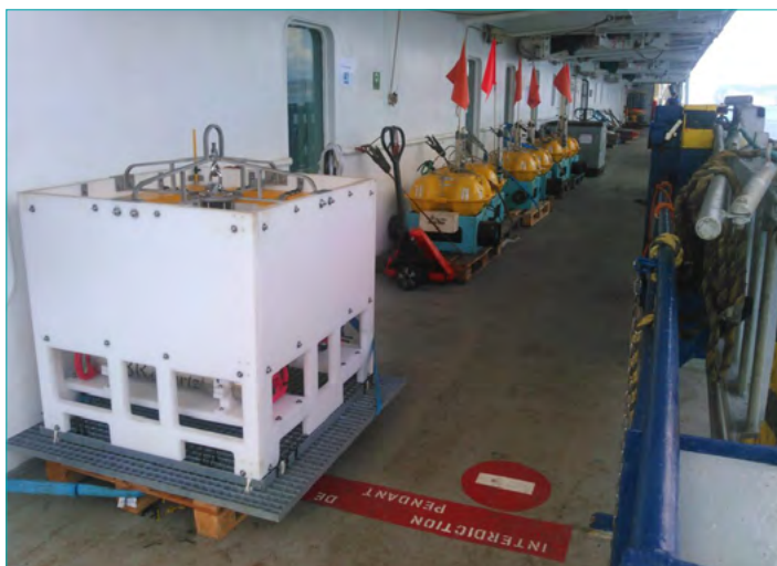
2 Le capteur A0A Résif et OBS CNRS-INSU prêts à être déployés sur le pont du navire Marion Dufresne lors de la campagne Mayobs15 à Mayotte © Denis Dausse
