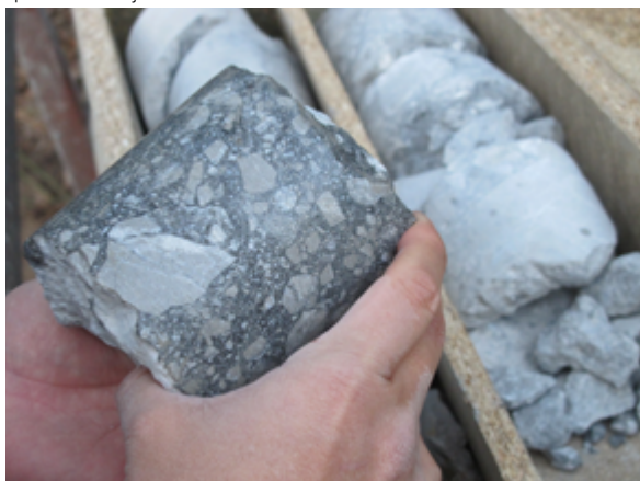
2 - La brèche de faille, constituée de fragments calcaires anguleux pris dans un mélange de sédiments argileux solidifié. © V. Bertrand
