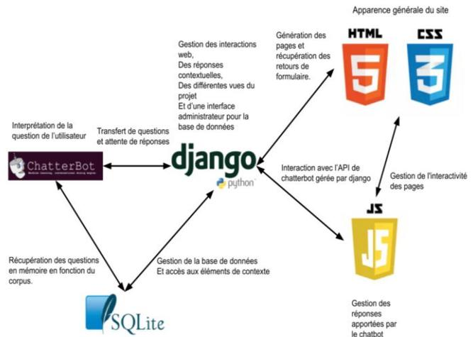
Figure 1. Schéma de l'application DEDALE
