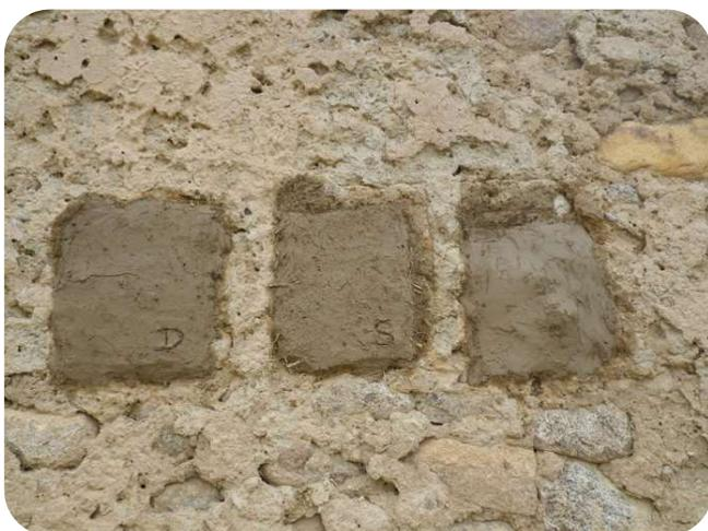
**Fig. 31 :** Vue rapprochée sur les enduits expérimentaux
