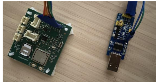
Figure 2. Montage pour téléverser le code Arduino à la carte OKKO.
