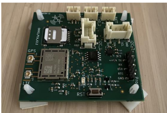
Figure 1. La carte OKKO: microcontrôleur ESP32-S2 + Modem LTE-M HL7800 + Connecteurs I2C.
