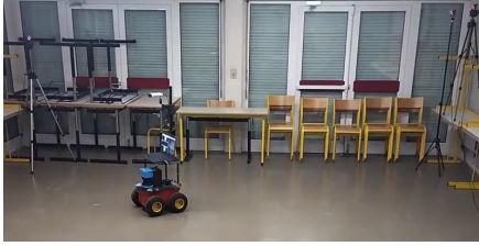
FIGURE 3 – Pioneer 3AT équipé d’une Azure Kinect DK évoluant dans le volume du système Optitrack
