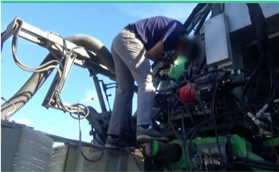
Figura 10: Intervención en el equipo para retirar el sensor GPS, © fotografía: Albert
