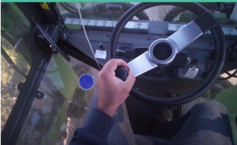
Figura 8: Comprobación del posicionamiento del pulverizador en la hilera mirando las huellas de los neumáticos (posición de la retina materializada por el punto azul y obtenida gracias a un oculómetro), © fotografía: Albert
