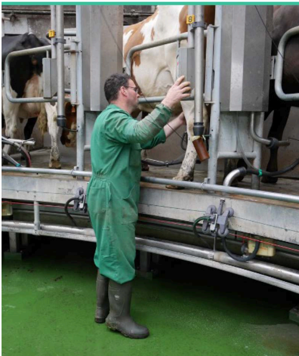
Figura 5: Un ganadero conecta las garras a una vaca (sala de ordeño rotativa con intervención del ganadero durante todo el proceso de ordeño). © fotografía: Pannetier
