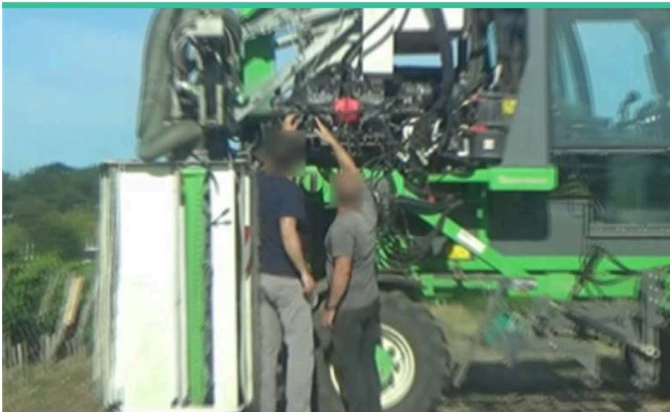
Figura 9: Intervención en el equipo para comprobar el estado del sensor GPS, © fotografía: Albert
