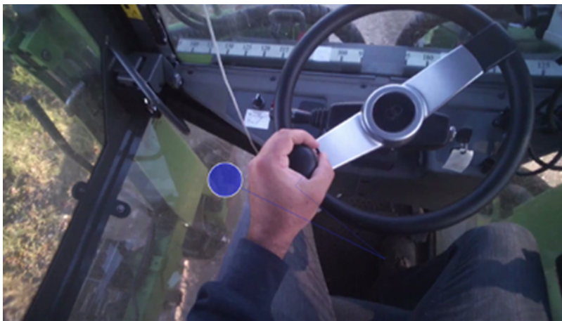
Figure 8 : Vérification du positionnement du pulvérisateur dans le rang en regardant les traces de pneus (position de la rétine matérialisée par le point bleu et obtenue grâce à un oculomètre), © fotografia : Albert
