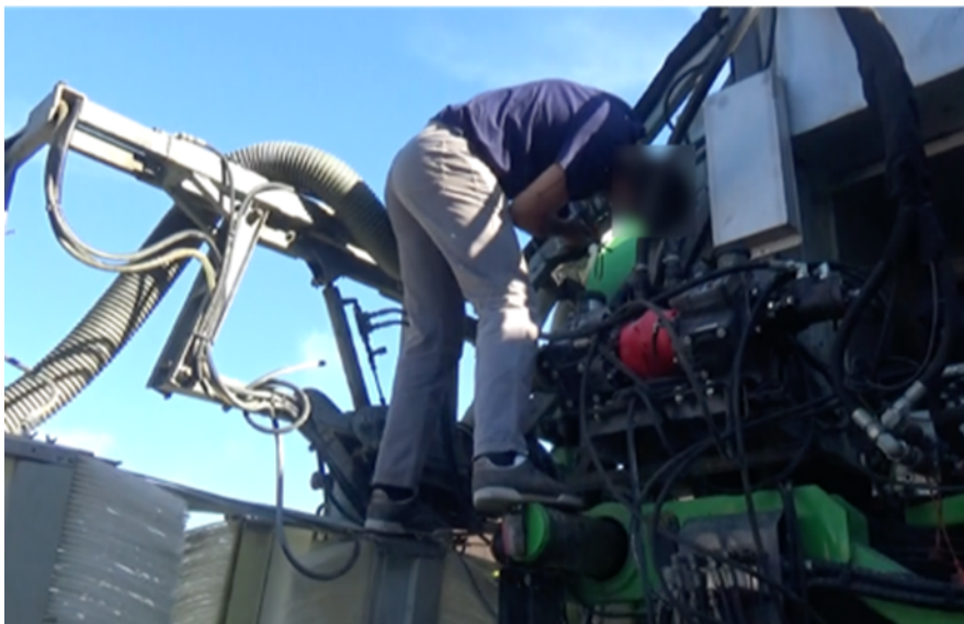
Figure 10 : Intervention sur le matériel pour retirer le capteur GPS, © fotografia : Albert
