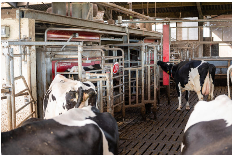
Figure 6 : robot de traite avec une vache en cours de traite et une autre en attente, © fotografia : Pannetier
