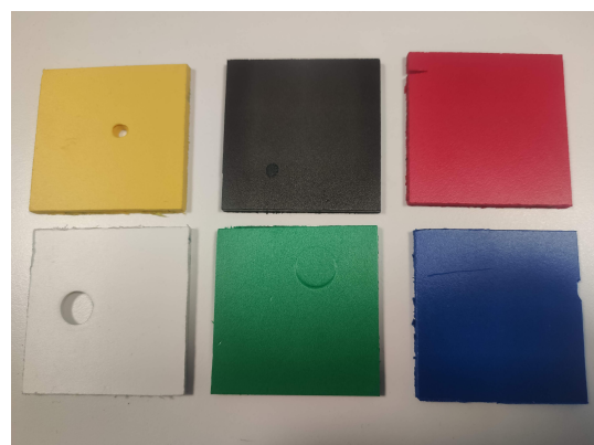
FIGURE 1 – Échantillon de pièces utilisées correspondant respectivement, de gauche à droite et de haut en bas, à un trou, une tâche, une encoche, un trou de diamètre différent, une marque et une rayure
