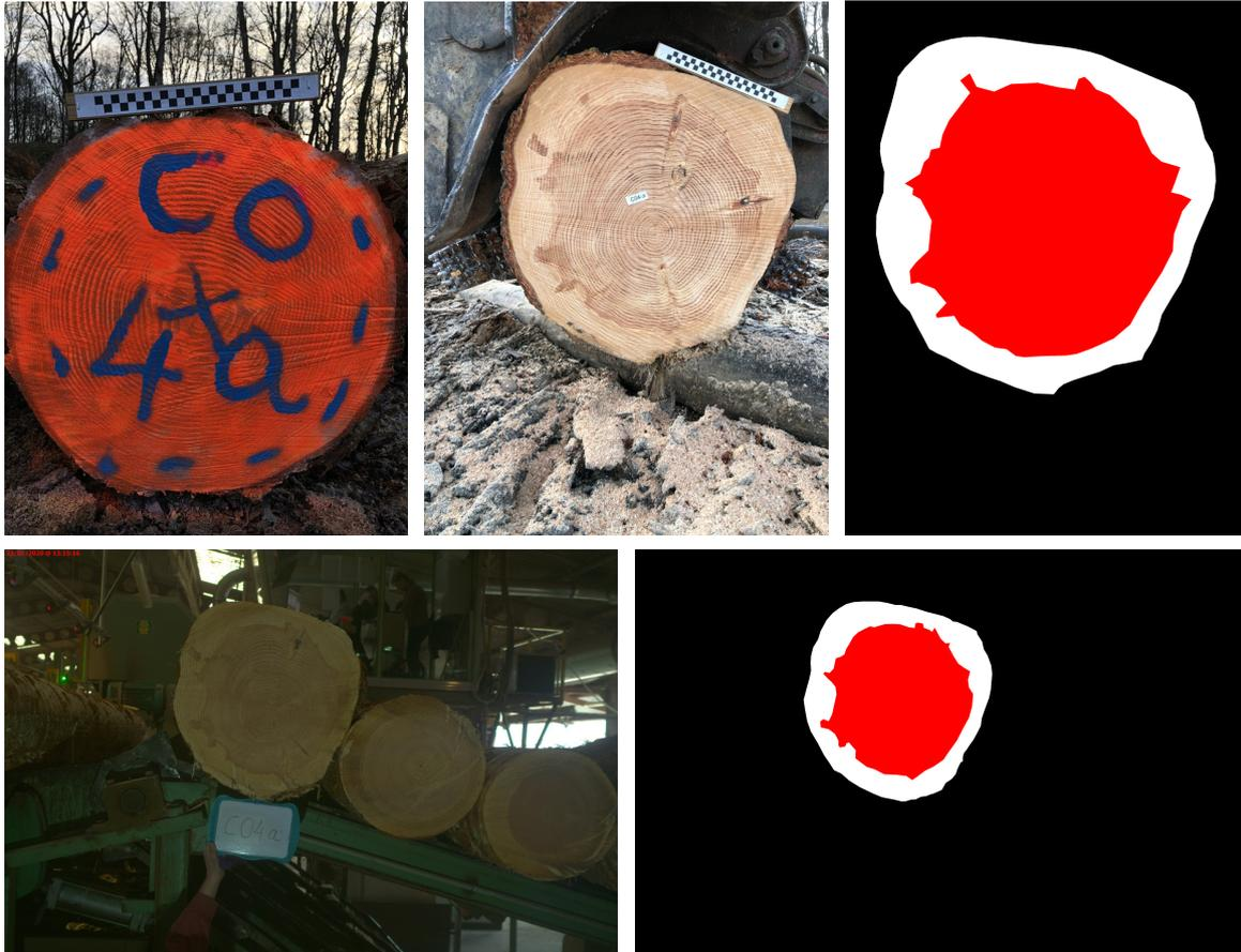
**FIGURE 3** – Exemples d'images du billon de Douglas C04a. En haut sur le parc à grume avec de gauche à droite le fin bout peint pour faciliter le repositionnement des planches, le gros bout tenu par une tête de tronçonnage et l'image segmentée manuellement de la section. En bas : gros bout vu depuis une caméra installée sur la chaîne de sciage et image segmentée de la section. Sur les images segmentées l'aubier est en blanc et le duramen en rouge.
