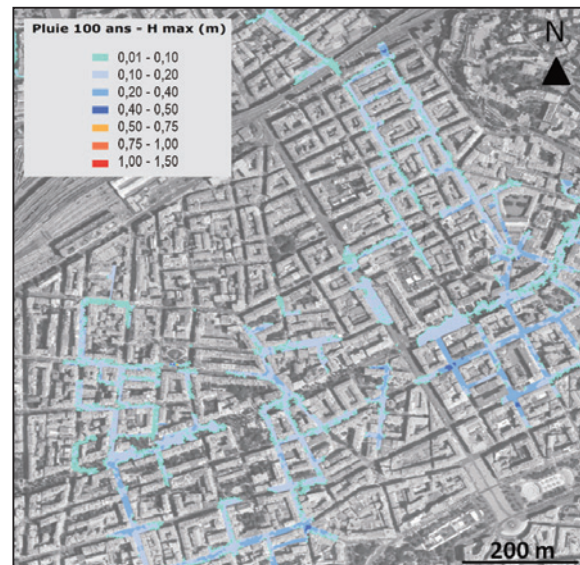
Figure 4. Hauteurs d'eau maximales calculées ( h_{max} ) sur le centre-ville de Nice – Pluie période de retour centennale (30 min – 4 h)
